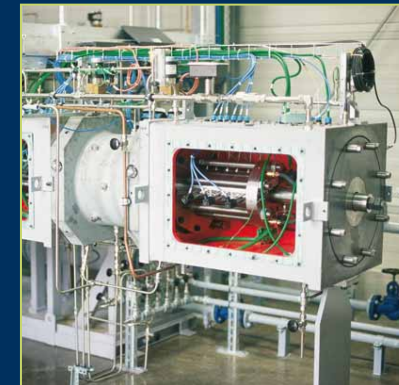
Kolbenstangendichtung und Zylindereinheit der FPM
